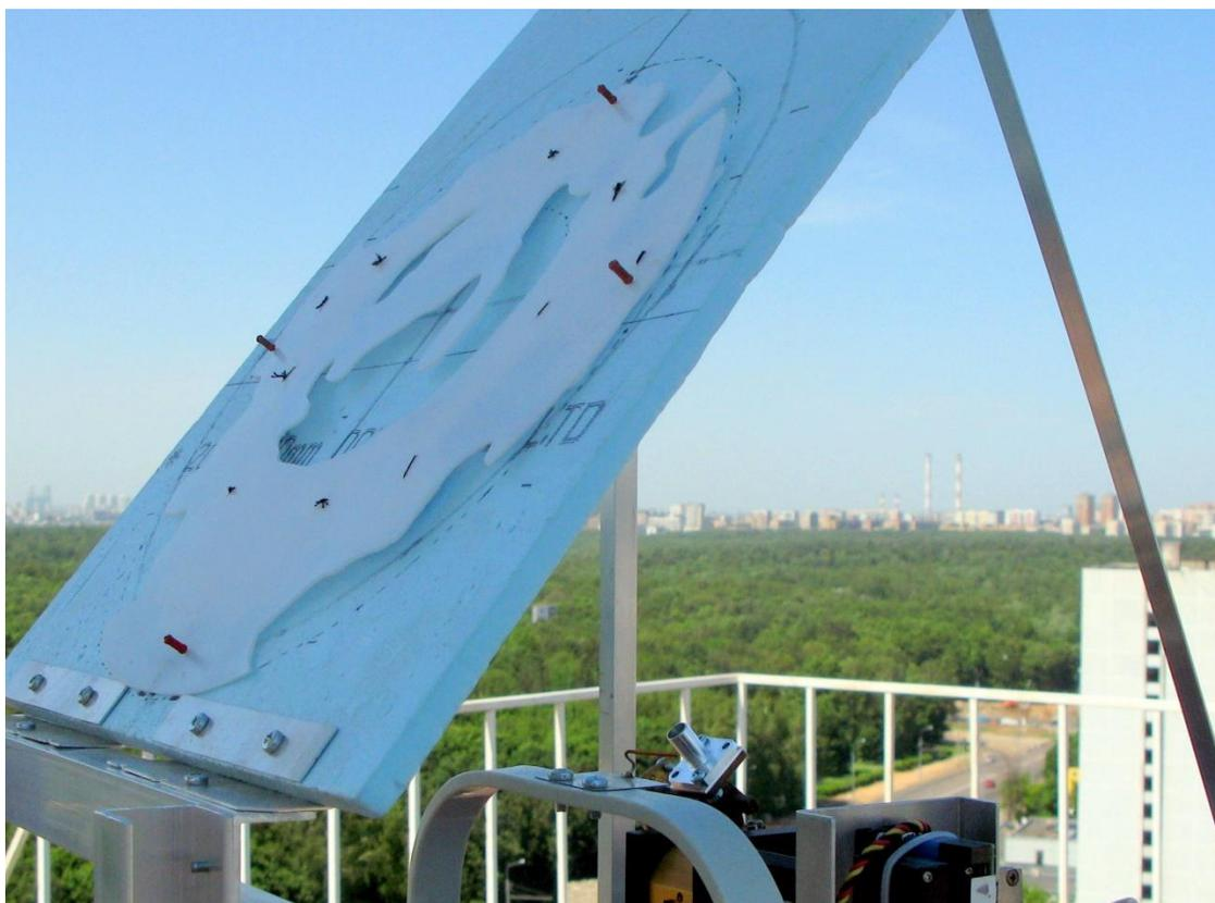
На фотографии хорошо виден облучатель, точная масштабированная копия двухмодового рупора, который я использовал на диапазоне 23 см. Результаты,
