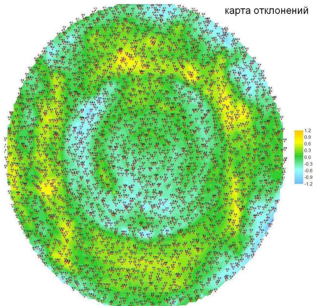
Здесь показана карта отклонений поверхности антенны от нового оптимального параболоида. Кстати хорошо видна деформация зеркала подзеркальником. Что это, кривой подзеркальником или следствие ударных ветровых нагрузок, сказать трудно.
