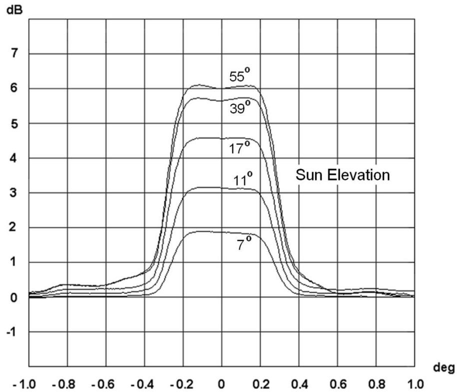
Измерения проведены при наличии корректирующей линзы. Ширина главного лепестка в 4.5 раза меньше углового размера Солнца, что позволяет видеть солнечный диск и его края. Семейство графиков позволяет оценить зависимость потерь в атмосфере от угла места антенны.
