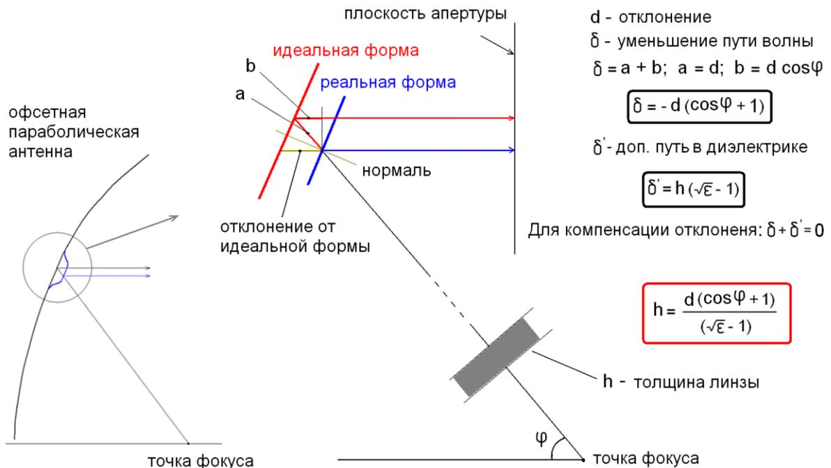
Результатом сканирования зеркала является так называемое облако точек, где каждая точка это одно измерение. Можно посчитать толщину диэлектрика для каждой точки зеркала, а затем перенести этот результат в плоскость линзы.
