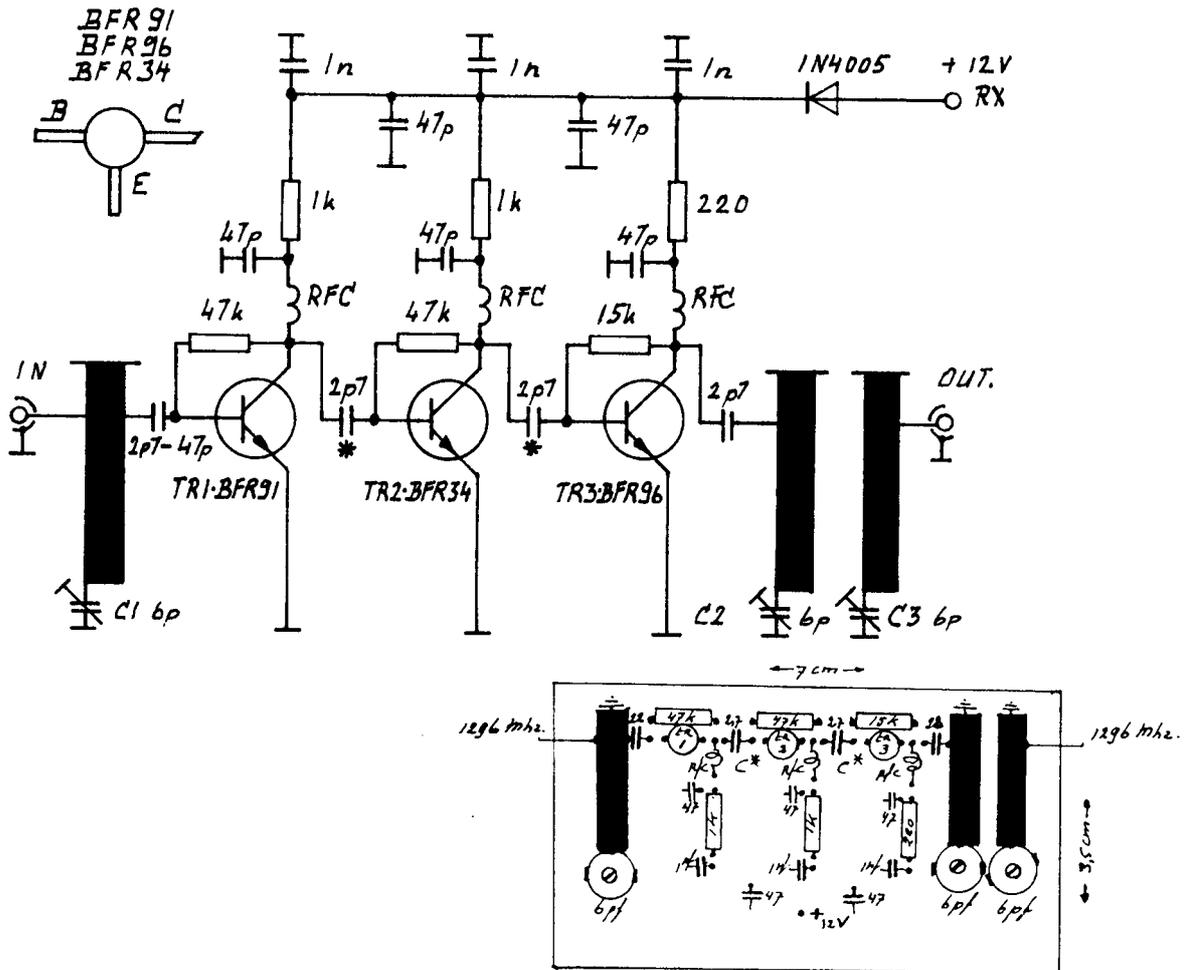
Vorverstärker 1296 MHz / Preamplifier 1296 MHz.
